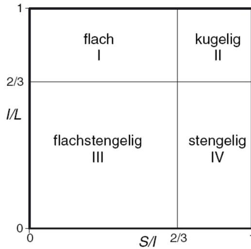
FIG. 5.3 – Diagramme de Zingg.  $L$ : longueur (axe  $a$ ),  $I$ : largeur (axe  $b$ ),  $S$ : épaisseur (axe  $c$ ) [Traduction: flach: disque; kugelig: sphère; stengelig: tige; flachstengelig: lame]
