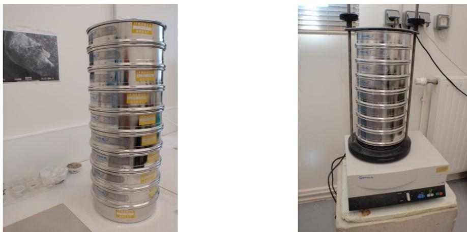
FIG. 3.8 – *Colonne de tamis et tamiseuse*
