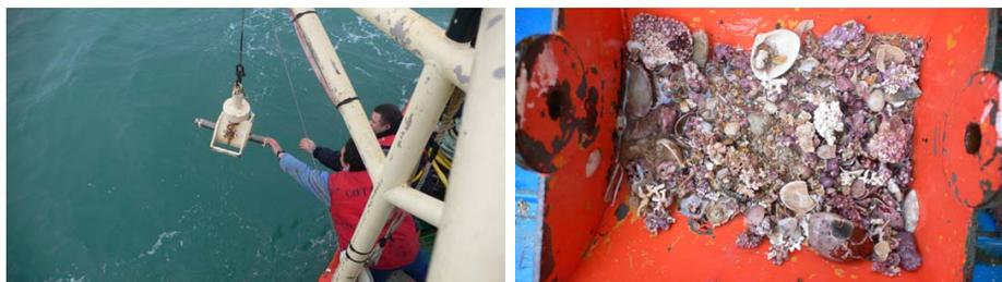
FIG. 3.2 – Benne à sédiment *Shipeck* à la remontée et ouverte avec son contenu de *maërl* (*Lithothamnium corallioides* et *Phymatholithon calcareum*). N/O Côtes d’Aquitaine CNRS
