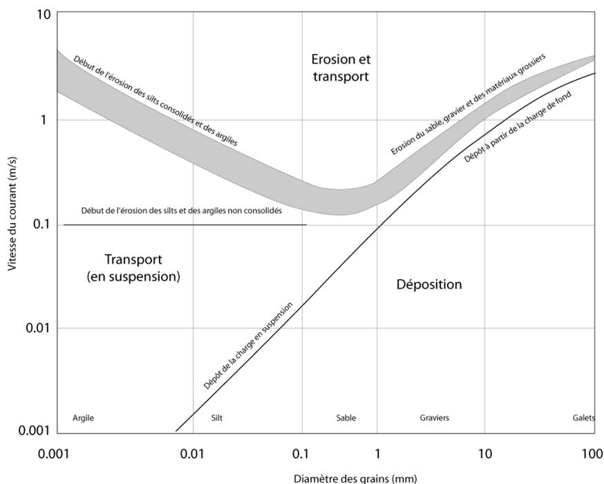
FIG. 4.8 – Diagramme de Hjulstrom. Relation entre la taille du grain, la vitesse de flux et le type de mouvement sédimentaire (densité du sédiment :  $2.65 \text{ g/cm}^{-3}$ )
