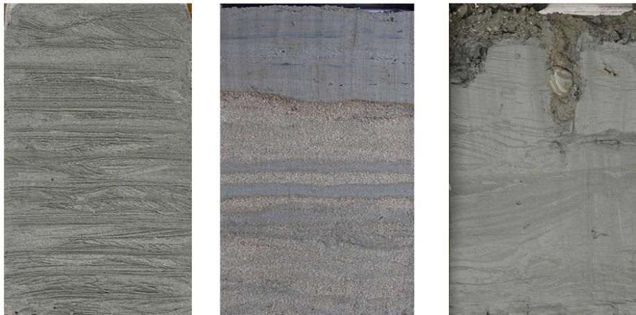
FIG. 2.4 – Echantillons prélevés par une boîte de Reineck et séchés
