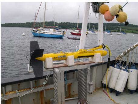
FIG. 6.2 – Sonar acoustique *EdgeTech* à bord du *N/O Serpula Heriot-Watt University, Edinburgh*
