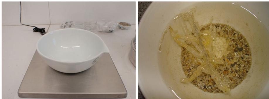
FIG. 3.4 – Capsule en porcelaine avec un sédiment biogénique décanté (tube coquillier de *Lanice conchilega*)
