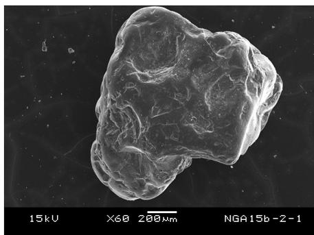
FIG. 1.2 – Grain de quartz vu au MEB. Notez les nombreux impacts mécaniques suite au tsunami de 2004 (Indonésie, cliché: R. Paris)
