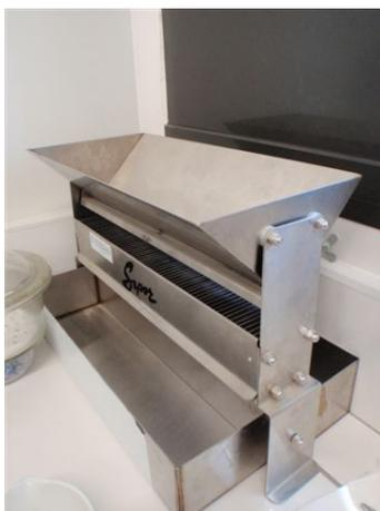
FIG. 3.6 – Séparateur de précision à riffle Jones
