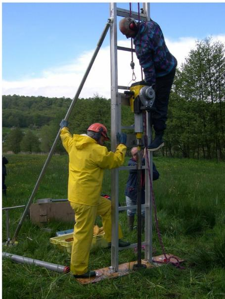
FIG. 2.7 – Carottier motorisé CNRS M2C Caen
